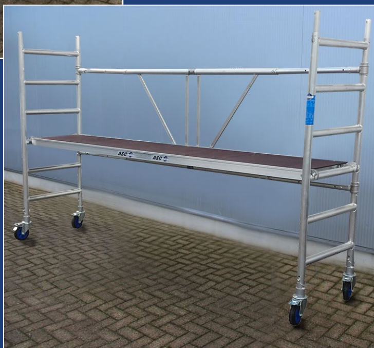
Teleskooppisen asennustelineen pituutta voidaan säätää, jolloin samassa asennustelinerungossa voidaan tilanteesta riippuen käyttää 1,90 m, 2,5 m ja 3,05 m pitkiä työtasoja.
